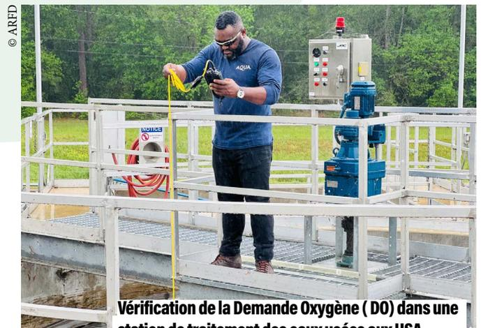
Vérification de la Demande Oxygène (DO) dans une station de traitement des eaux usées aux USA
